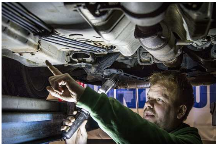
Vladimír Trendl z firmy Autoklempřivství.cz ukazuje na jedno z typických ložisek rzi ve spoji dvou dílů.
