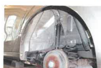
Výfuk ještě nějaký čas vydrží, pod plastovým podběhem je čisto. Bílé skvrny na podlaze a svarech tunelu ale volají o pomoc.
