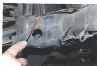
Hlubší než povrchavou korozi vykazuje zadní náprava, i ta stojí za ošetření
