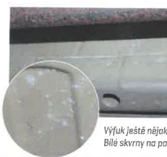
Hlubší než povrchavou korozi vykazuje zadní náprava, i ta stojí za ošetření
