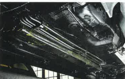
KRITICKÝ drobný pohled pracovníků STK se zaměřuje také na stav brzdového potrubí. Oprávněně!
