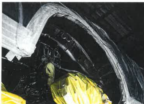
PODBĚHY jsou extrémně namáhaným místem. Kvalitní ošetření žádá odstrojění všech krytů.
