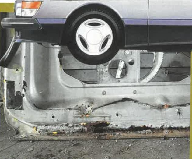
**SPODNÍ ČÁST** dveří je dalším z kritických míst. Okolo těsnění okna se do jejich útrob dostává vlhkost i nečistoty. U Saabu 900 bylo ještě možné postižené místo opravit, často už to ale nejde.
