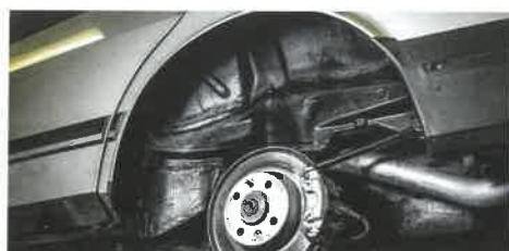
Podběhy jsou extrémně namáhaným místem. Kvalitní ošetření žádá odstrojení všech krytů.
